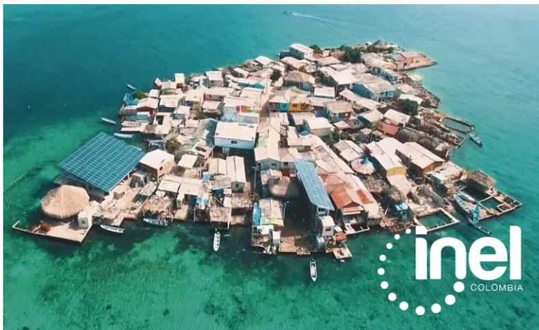
Microredes de 150 kWp, 40 kWp y 30 kWp. 980 paneles instalados / 5,1530 kWp en baterías.
